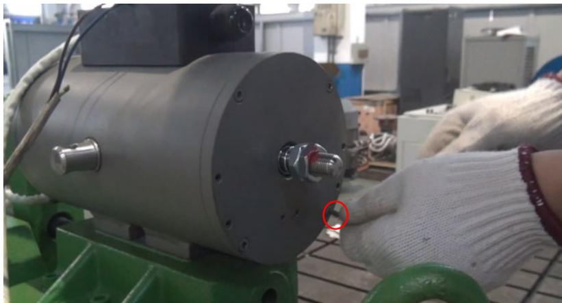
4. 掰动松闸杆，顶出动铁芯组件，将动铁芯组件取下。
