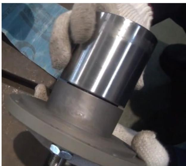
5. 松开两件螺母 M16，取下弹簧，分离动铁芯和静铁芯
